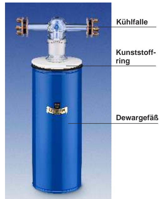
Kühlfalle KF 29 NW16-Z mit Dewar und Auflagering
